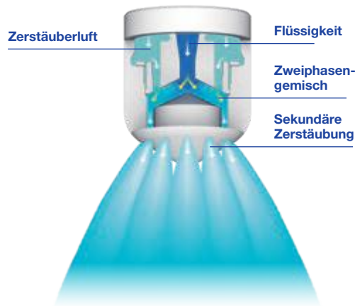
Schematische Darstellung der VarioJet® Düse
